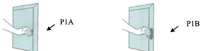
Figura 2.6 – Fixação do sensor magnético de portas
